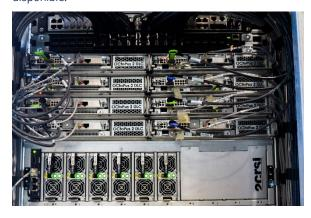
Conçu pour simplifier les opérations de maintenance, le serveur OCtoPus 2 en DLC permet un accès intégral depuis l'avant, offrant ainsi une accessibilité accrue pour l'entretien. Chaque nœud est autonome et conçu spécifiquement pour supporter le DLC grâce à des connecteurs adaptés.
