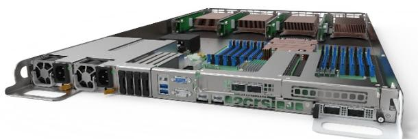
C'est un serveur 21 pouces équipé des 4 emplacements pour des accélérateurs type cartes graphiques ou FPGA et un emplacement pour les processeurs AMD de dernière génération.
