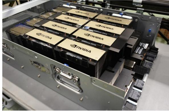
Par ailleurs, malgré la consommation importante des 8 H100 GPU, ce serveur intègre un système de refroidissement avancé, essentiel pour maintenir les performances optimales de ses composants sous des charges de travail intenses. Il utilise un refroidissement à air avec des ventilateurs haute efficacité pour dissiper la chaleur générée par les processeurs et les GPU.
